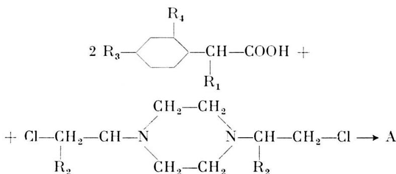
Ou encore, par condensation des esters chloréthyliques des acides phénylacétiques  $\alpha$ -substitués avec l'hydrate de pipérazine :
