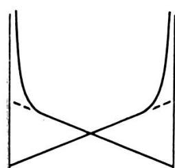
par une courbe à tendance asymptotique, et non par une de ces droites caractérisant le travail de ressorts hélicoïdaux simples. (Flèche en abscisse, charge en ordonnée.)
