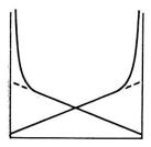
compression crée une résistance rapidement croissante, qui se traduit, sur un diagramme, par une courbe à tendance asymptotique, et non par une de ces droites caractérisant le travail de ressorts hélicoïdaux simples. (Flèche en abscisse, charge en ordonnée.)
