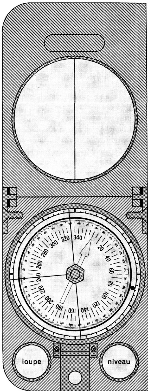
2) L'axe de l'aiguille aimantée est compris entre deux rubis et dispose ainsi d'une liberté extrême, tout comme dans le balancier d'une montre. Pas plus que la bille d'or, ce dispositif ne réclame d'immobilisation lorsqu'on ne s'en sert pas, et l'on peut ainsi, sans crainte de détérioration, gagner un temps très appréciable si l'on additionne les innombrables opérations de serrage et desserrage que requiert une boussole ordinaire.
