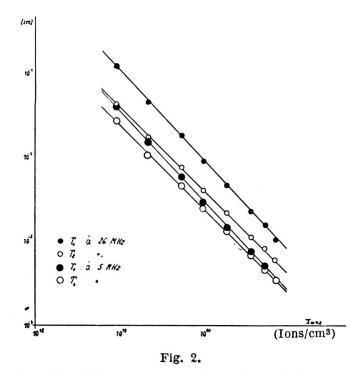
Temps de relaxation T<sub>1</sub> et T<sub>2</sub> des protons dans des solutions aqueuses de TiCl<sub>3</sub> à 26 Mc/s et à 5 Mc/s. Mesure effectuée 5 heures après la préparation des solutions, à la température de 25°C.
