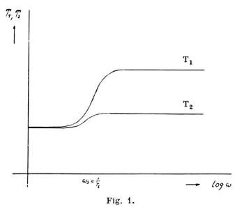
Temps de relaxation  $T_1$  et  $T_2$  des protons dans des solutions aqueuses d'ions paramagnétiques en fonction de la fréquence, dans le cas où  $\tau_{\rm S} > 10^{-11}$  sec, d'après la théorie de Bloembergen.
