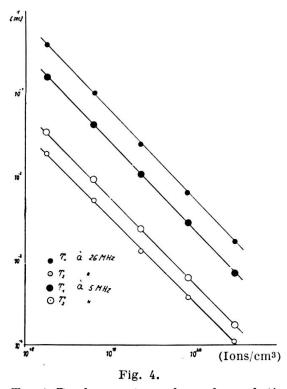
Temps de relaxation  $T_1$  et  $T_2$  des protons dans des solutions de  $VOSO_4$  dans  $H_2SO_4$  normal, à 26 Mc/s et à 5 Mc/s. Mesure effectuée 5 heures après la préparation des solutions, à la température de 25°C.
