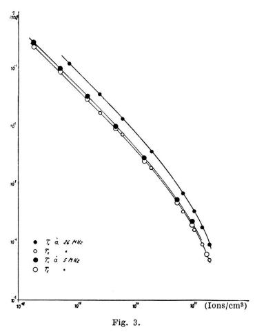
Temps de relaxation  $T_1$  et  $T_2$  des protons dans des solutions aqueuses de  $VOSO_4$  à 26 Mc/s et à 5 Mc/s. Mesure effectuée 5 heures après la préparation des solutions, à la température de 25°C.
