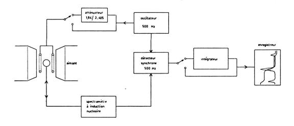
Fig. 2 Schema en bloc du spectromètre avec modulation bande-laterale et intégrateur
