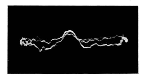
${\bf Fig.~1.}$  Raie de résonance quadrupolaire obtenue avec le montage de  ${\bf Wang}$
