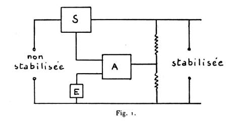
dont la tension de sortie est proportionnelle à la différence entre une fraction de la tension stabilisée et une tension de référence E.
