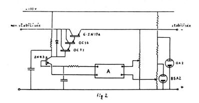
sont commandés par un amplificateur de puissance (OC16 et OC71). Un transistor 2N43 réalise la jonction entre l'amplificateur AMC12 et l'amplificateur de puissance; il inverse la phase et permet d'appliquer correctement la tension de contreréaction.
