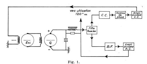
Schéma de principe de régulation lente et régulation rapide de la tension aux bornes du groupe générateur
