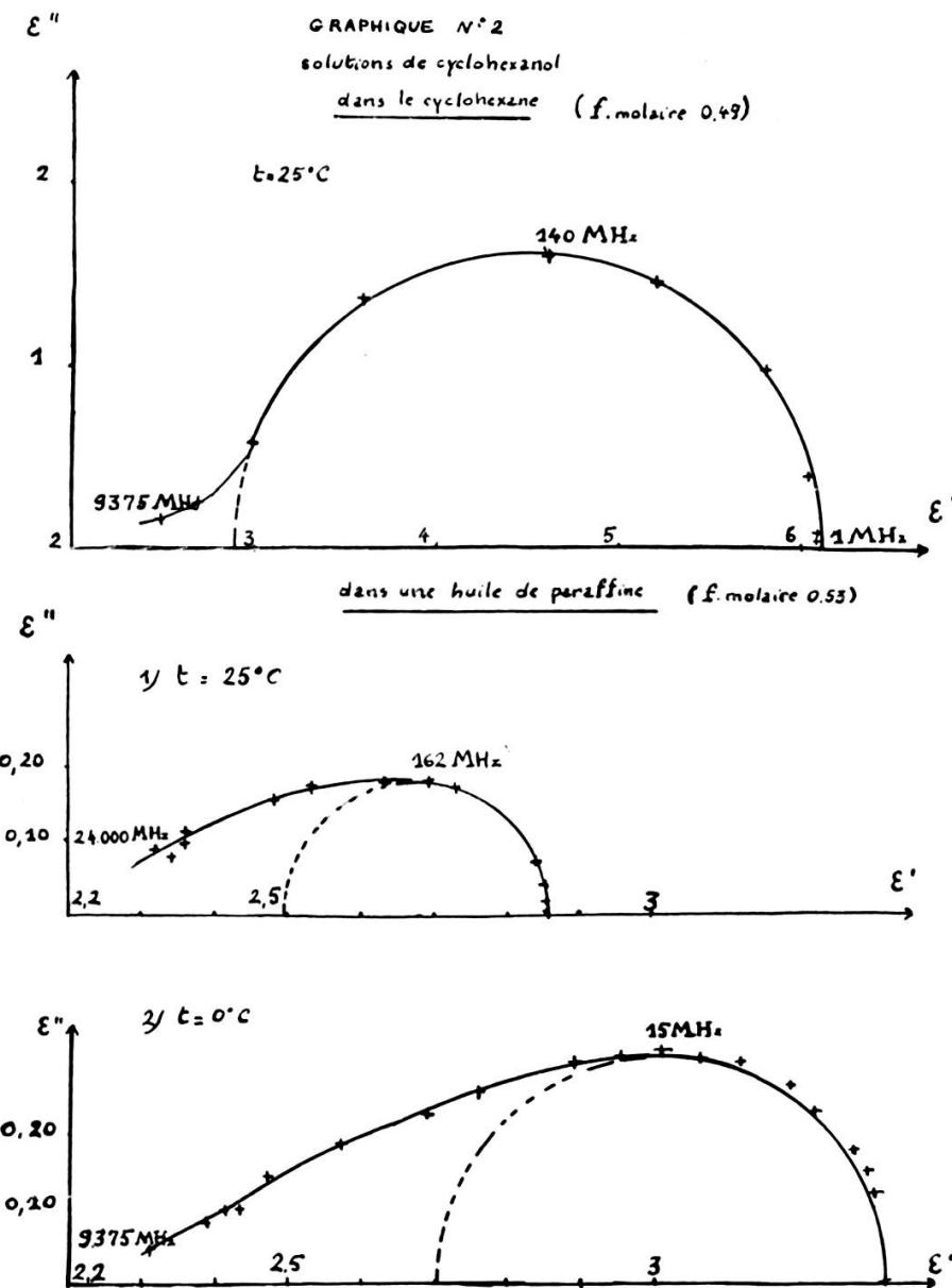
Les spectres hertziens des solutions de cyclohexanol considérées s'étendent depuis 0,6 à 10.000 MHz et parfois jusqu'à 24.000 MHz. Dans la représentation de Cole et Cole  $\epsilon'' = \varphi(\epsilon')$ , l'allure de l'ensemble des bandes d'absorption varie avec le solvant, la température et la concentration. Les modifications considérées concernent essentiellement les écarts entre le spectre réel et l'allure circulaire classique (Debye): demi-cercle obtenu en
