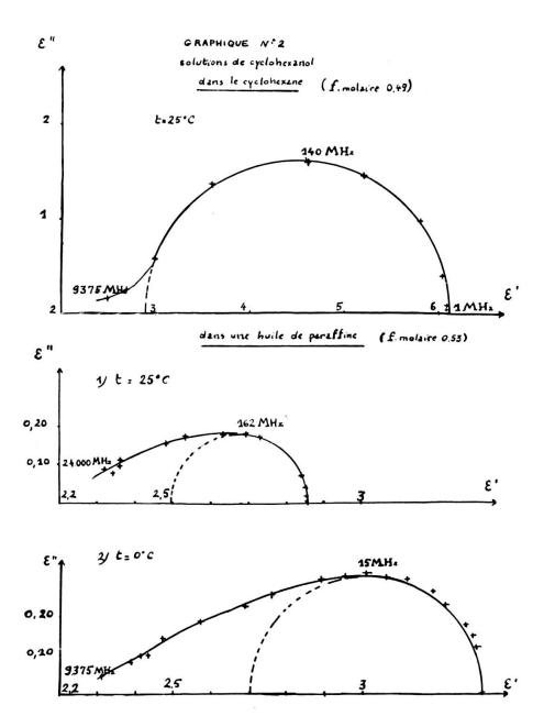
Les spectres hertziens des solutions de cyclohexanol considérées s'étendent depuis 0,6 à 10.000 MHz et parfois jusqu'à 24.000 MHz. Dans la représentation de Cole et Cole  $\epsilon'' = \varphi\left(\epsilon'\right)$ , l'allure de l'ensemble des bandes d'absorption varie avec le solvant, la température et la concentration. Les modifications considérées concernent essentiellement les écarts entre le spectre réel et l'allure circulaire classique (Debye): demi-cercle obtenu en
