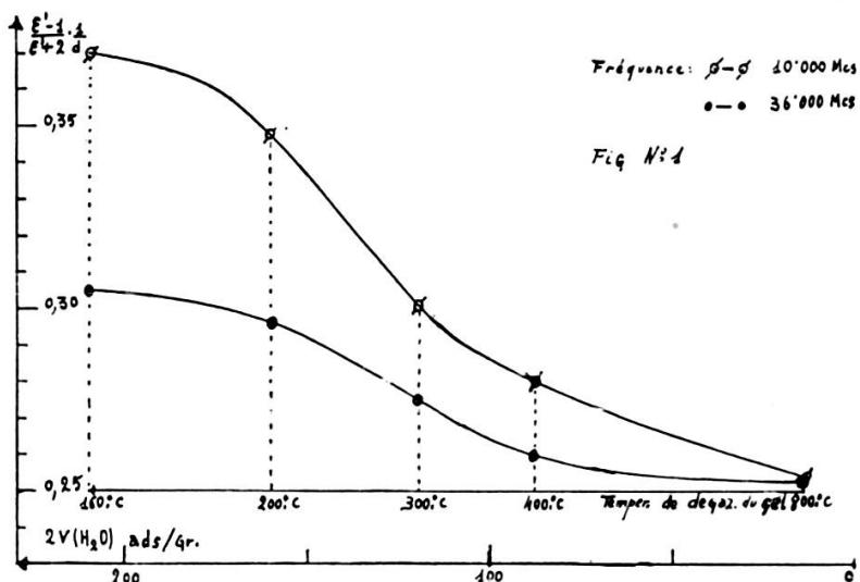
35.000 Mcs. Le gel est préalablement dégazé sous vide à une température donnée pendant six heures et introduit sous vide dans la cellule.
