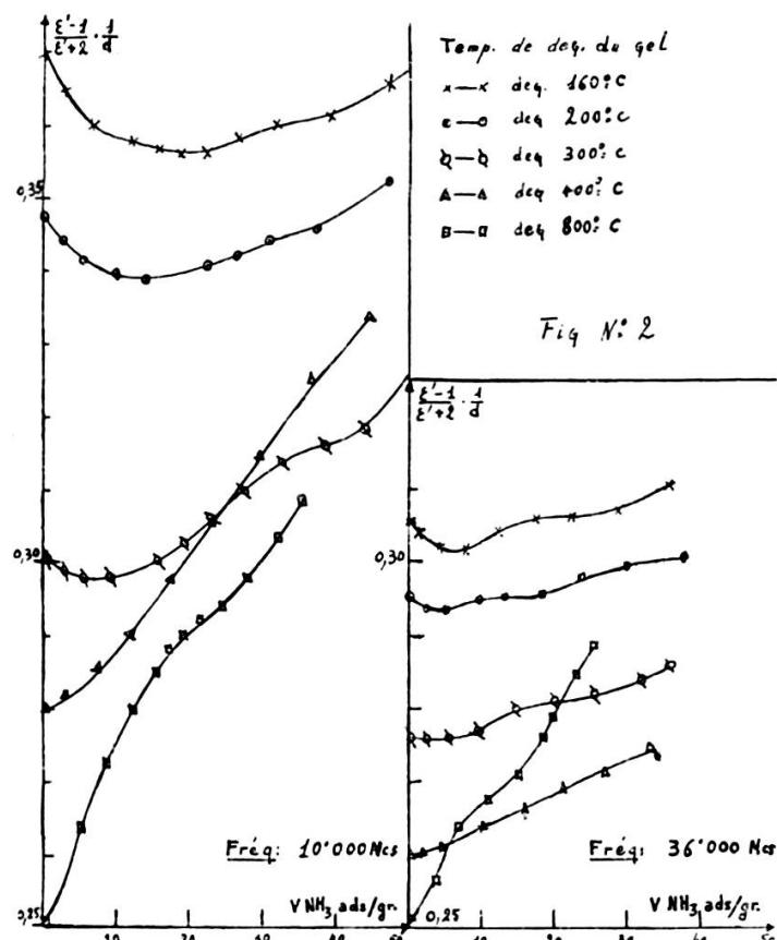
samment long pour que la contribution à  $\epsilon'$  soit minime aux fréquences de mesure. On peut remarquer de plus que les courbes représentant  $P$  pour les deux fréquences utilisées se déduisent l'une de l'autre par affinité suivant l'axe des  $P$ , ce qui permet dans l'hypothèse évidemment un peu simpliste de deux formes de l'eau fixée, d'en déterminer le pourcentage pour chaque degré d'hydratation du gel.
