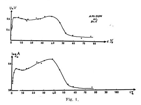
La figure 1 rassemble les résultats obtenus pour U et log A. Trois régions sont à distinguer: 1°: de 0 à 2% environ, U voisin de 0,45 eV correspondrait aux liaisons hydrogène des oxydriles de l'amidon; 2°: de 2 à 25% environ, U passe de 0,64 à 0,60 eV, correspondant aux molécules d'eau fixées sur l'amidon; 3°: à partir de 40%, U décroît jusqu'à 0,28 eV; il s'agit d'eau libre absorbée.
