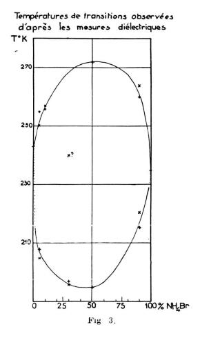
aussi bien au refroidissement qu'au réchauffement; la vitesse était de 20° à l'heure environ. Chaque produit était étudié simultanément aux quatre fréquences suivantes: 10<sup>2</sup>, 10<sup>3</sup>, 10<sup>4</sup> et 10<sup>6</sup> Hz.
