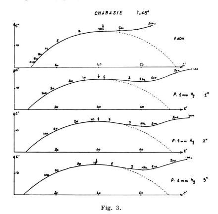
Evolution du diagramme de Cole-Cole au cours d'un départ partiel d'eau à température constante.
