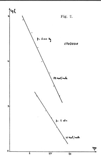
$\varepsilon_{\infty}$  et  $\varepsilon_{01}$  ont des valeurs constantes voisines de 8 et 65 respectivement. Le tracé de la droite  $\log fc$ ,  $\frac{1}{T}$  (fig. 2) permet la mesure de l'énergie et de l'entropie d'activation.
