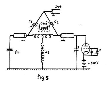
valeurs de la fréquence et de la conductance. On peut utiliser la conductance de l'espace cathode-anode de tubes triodes [2]. On obtient ainsi des variations de 0,1 à 100 ou 300  $\mu$  mho suivant les tubes. En plaçant des résistances fixes (disposées dans des fiches dont la réalisation permet d'obtenir d'excellents contacts) en parallèle sur le tube triode, les mesures sont possibles jusqu'à 1.500  $\mu$  mho. Le schéma d'un tube utilisé en conductance variable est donné figure 5.
