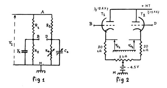
de même avec  $\frac{R_1}{R_3}=$  10, la mesure du dipôle  $R_{px}=$  100  $k\Omega$ ,  $C_{px}=$  0,01  $\mu F$  est bonne.
