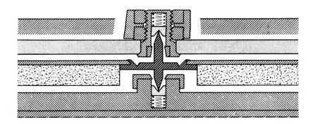
J'ai obtenu, en effet, d'excellents résultats avec le dispositif figuré ci-dessus, où les rubis, coulissant dans un tube, sont soumis à l'action de ressorts hélicoïdaux qui les appliquent constamment contre le pivot avec une légère pression (une vis de réglage pouvant naturellement être ajoutée à ce dispositif pour modifier la tension des ressorts).
