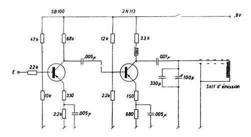
Amplificateur Haute Fréquence
