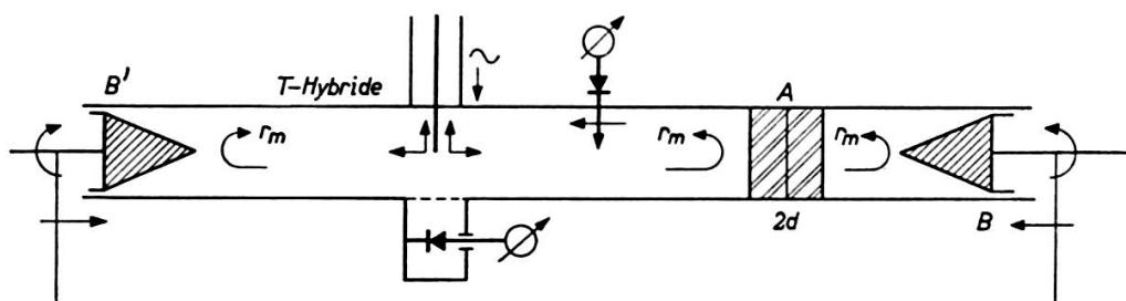
Ce dispositif est compliqué, mais nous avons trouvé une solution pratique très simple. Quand on tourne en A le plan de polarisation de l'onde incidente de  $90^\circ$ , il est possible d'éliminer une terminaison variable. De cette manière on obtient:
