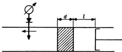
La ligne est court-circuitée par un piston. Quand  $l = 0$ , on mesure l'impédance:
