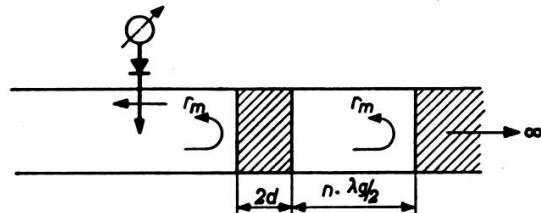
On mesure encore la même impédance  $Z_m$  dans la ligne quand on enlève l'échantillon sur une longueur de  $n \cdot \lambda g/2$  (les pertes du guide étant négligées). La réflexion
