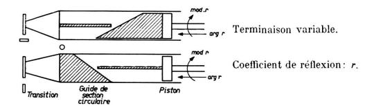
Dans un guide de section circulaire se trouvent deux lames absorbantes. L'une d'elles est fixée dans le guide, l'autre est montée dans un piston qui peut faire un mouvement de translation et un mouvement de rotation.
