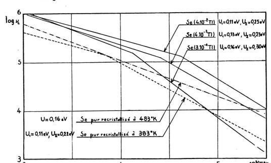
Energies d'activation de divers échantillons de Sélénium.
