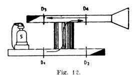
Utilisation d'un coupleur non réciproque pour protéger un oscillateur contre les réflexions en bout d'un feeder long.
