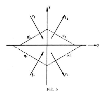
Ondes transmises et réfléchies par un semi-réflecteur plan.
