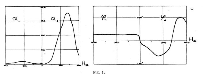
en pont [1], nous avons fait ces mesures sur divers ferrites à la fréquence de 9400 Mhz. La figure 1 montre les variations du déphasage  $\varphi_{\pm}$  et de l'atténuation  $\alpha_{\pm}$  subies au cours de la propagation dans un barreau mince de ferrite de nickel; les courbes de  $\varphi_{\pm}$  ont une allure désormais classique; en effet, selon la théorie élémentaire de l'effet Faraday [2] pour des ondes planes:
