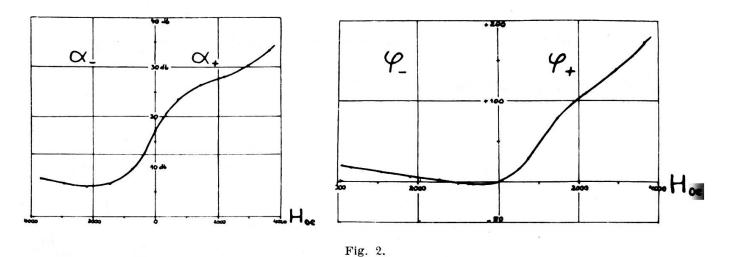
Les différences entre  $\alpha_{\pm}$  montrent clairement l'utilité d'un tel ferrite pour la réalisation d'isolateurs en guide d'onde rectangulaire, appareils désormais classiques; à l'aide du ferrite de nickel ci-dessus, nous avons réalisé un isolateur ayant une atténuation directe inférieure à 0,5 db dans la bande 8500 à 10 000 Mhz et une atténuation inverse supérieure à 15 db dans la même bande.
