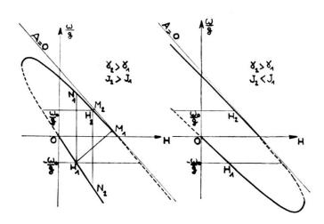
tracées pour deux températures situées de part et d'autre du point de compensation magnétique (lorsqu'il existe).
