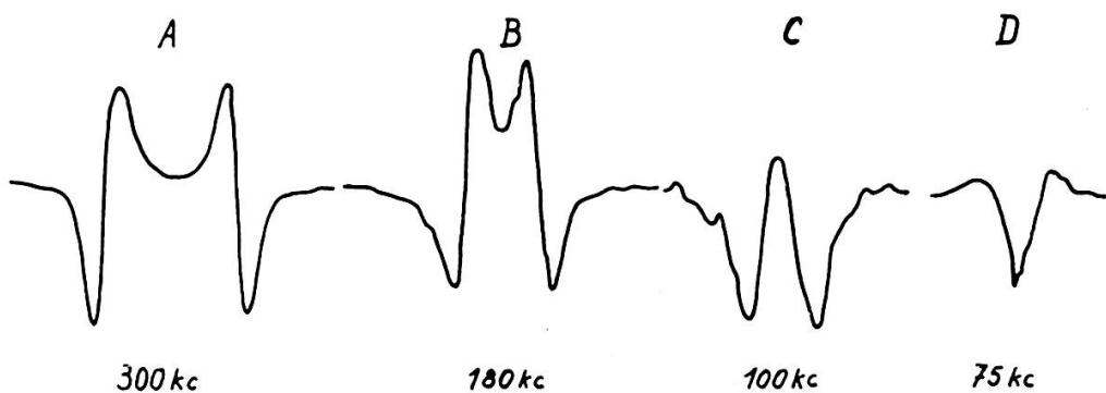
nous avons utilisé un générateur HF Férisol pilotant un amplificateur résonant. A ces fréquences, la résonance se produit pour des champs magnétiques de l'ordre de 50 mOe.; il est donc nécessaire de compenser la majeure partie du champ magnétique terrestre.
