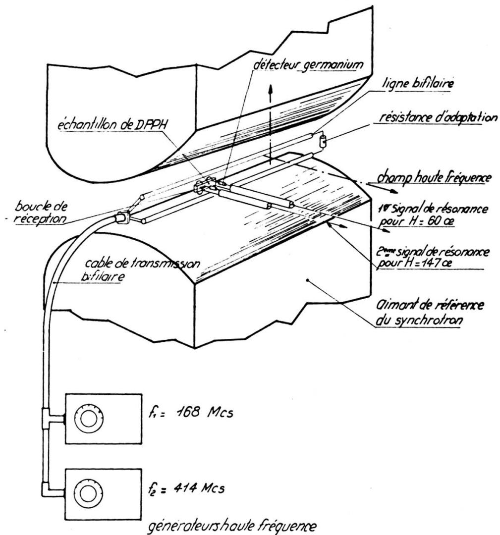
Cet appareil servira à donner deux impulsions successives aux instants où le champ magnétique croissant du Synchrotron à Protons traverse deux valeurs instantanées importantes. Ces impulsions commandent l'injection du faisceau de Proton dans le Synchrotron.
