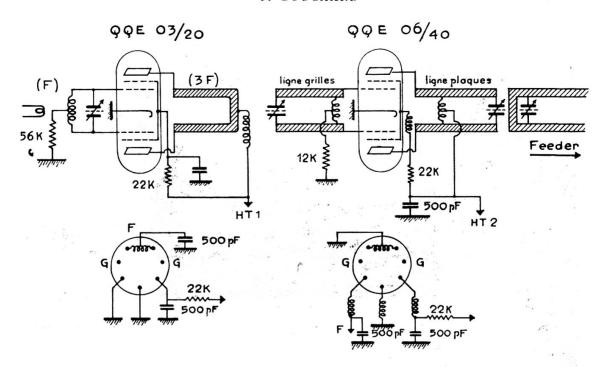
La boucle de couplage du circuit de sortie est accordée par un condensateur papillon pour adapter au mieux l'impédance du feeder; elle est placée au voisinage du ventre d'intensité sur la ligne plaques.
