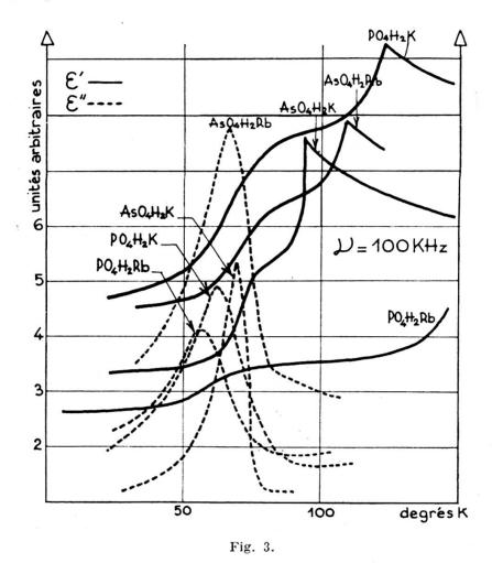
II. Phosphates et arséniates alcalins ferroélectriques.
