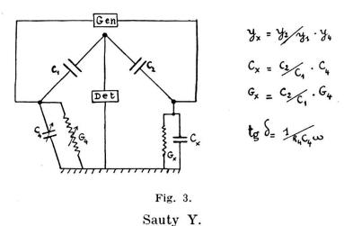
Sous la forme la plus simple, ces ponts sont à « tête » équilibrée: deux résistances R<sub>1</sub> R<sub>2</sub> égales, ou mieux: deux capacités C<sub>1</sub> C<sub>2</sub> égales.
