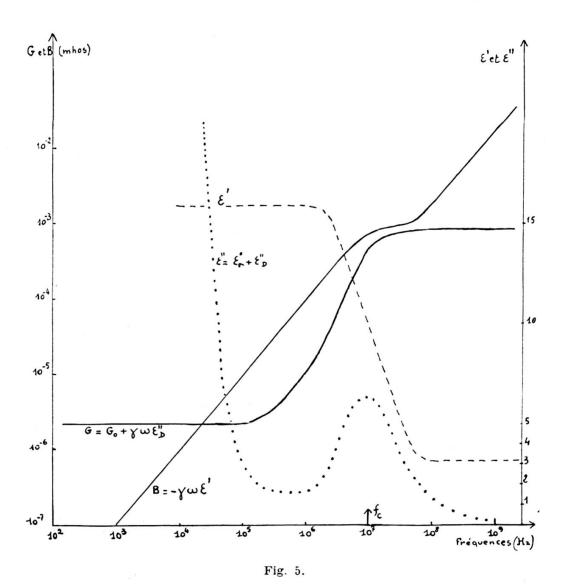
Valeurs de la conductance, de la susceptance, de s' et s'' pour une cellule (capacité active 1 pF) remplie d'un diélectrique.
