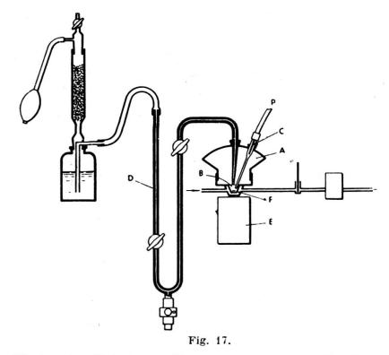
Electromicrotitrimètre utilisé pour la mesure de l'activité des cholinestérases.
