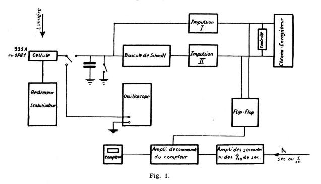
Schéma de principe du photomètre photoélectrique.
