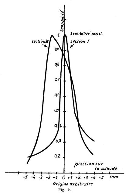
Sensibilité en fonction de la position de l'image sur la photocathode selon deux sections différentes (la sensibilité maximum de la section est réduite à 1)
