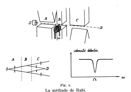
zontalement dans le champ  $H_z$ , il éprouvera une déviation proportionnelle à la force, donc au produit  $M_z \cdot \frac{\partial H_z}{\partial z}$ . Lorsqu'un jet d'atomes de spin I est ainsi projeté, deux effets se produiront:
