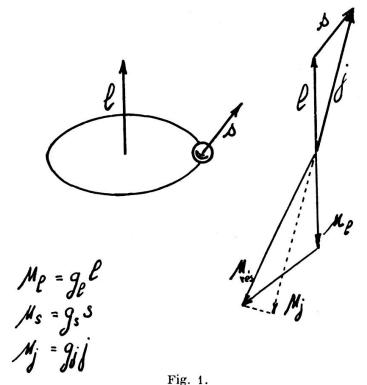
Composition des quantités de rotation et des moments magnétiques d'un électron atomique.
