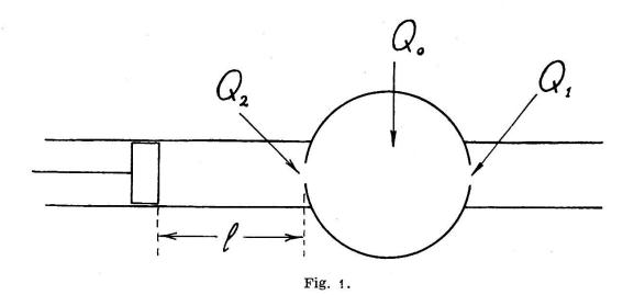
tant de déterminer la différence de fréquence entre la cavité à étudier et une cavité étalon à laquelle elle est couplée. Si les deux cayités ont la même fréquence propre, on observe une courbe de résonance symétrique avec deux sommets. Si l'une des deux fréquences de résonance varie légèrement par rapport
