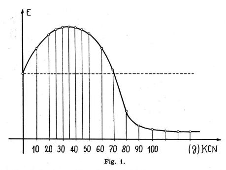
Variation de la vitesse d'oxydation du Nadi catalysée par 50  $\gamma$  Cu  $^{+2}$  ionique en fonction de quantités croissantes de CNK.
