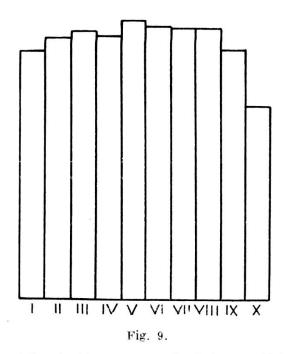
Histogramme réel calculé, correspondant à une distribution réelle continue avec diamètres variant de 0 à 10 mm. En abscisse: diamètres réels; en ordonnée: fréquence des classes.
