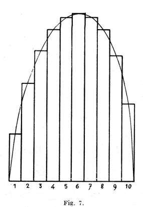
Courbe de la distribution apparente et histogramme correspondant dans le càs d'une distribution réelle continue avec diamètres variant de 0 à 10 mm. En abscisse: diamètres apparents; en ordonnée: fréquence des classes.
