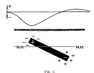
Cas d'un filon (ou d'une masse allongée) incliné par rapport à la surface du sol donnant une courbe de potentiel dont la partie négative est à l'aplomb de la tête, alors que la partie positive est plus ou moins placée sur le point le plus profond.
