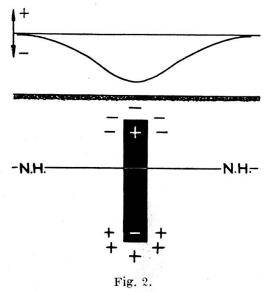
Cas d'un filon (ou d'une masse allongée) placé perpendiculairement à la surface du sol donnant une courbe symétrique de potentiel négatif.
