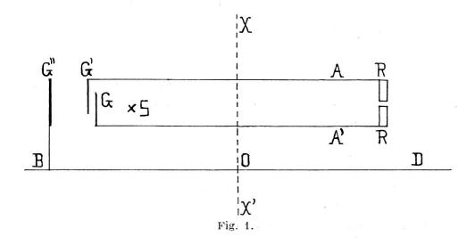
étalon réglé pour donner des franges à l'infini, et légèrement incliné sur le précédent. L'ensemble devait constituer des franges de superposition localisées à l'infini, visibles en lumière blanche émise par la source intermittente S, et pouvant être photographiées dans l'appareil L solidaire du disque D et pointé sur l'infini.
