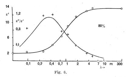
Courbes de dispersion et d'absorption de l'alcool iso-butylique dissous dans le benzène (90 et 80%).
