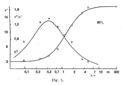
Courbes de dispersion et d'absorption de l'alcool iso-butylique pur (100%) et dissous dans le benzène (95%).
