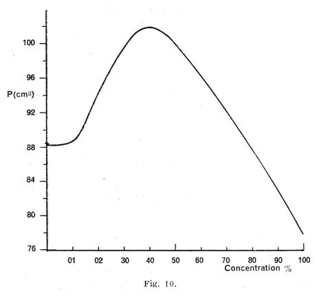
Polarisation moléculaire de l'alcool iso-butylique dissous dans le benzène en fonction de la concentration.
