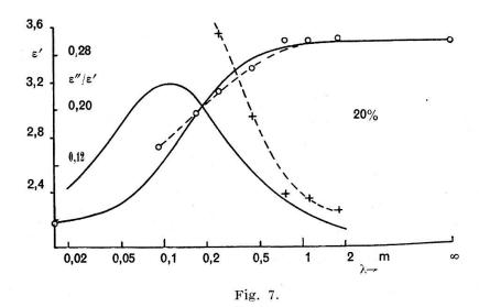
Courbes de dispersion et d'absorption de l'alcool iso-butylique dissous dans le benzène (50 et 20%).
