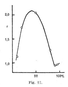
Rapport entre les valeurs de  $\tau/\eta$  de l'alcool iso-butylique dissous dans le benzène et celles de l'alcool pur en fonction de la concentration.
