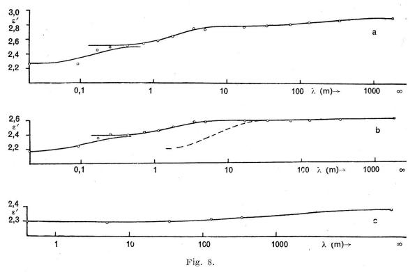
Courbes de dispersion de l'alcool iso-butylique dissous dans l'huile Texaco (courbe a) et dans l'huile de paraffine (courbe b). En bas courbe de dispersion de l'huile Texaco (courbe c).
