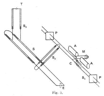
M: magnétron, A: électro-aimant, S: système principal de Lecher (système de mesure),  $S_1$ : système d'accord,  $S_2$ : système auxiliaire,  $S_3$ : système détecteur, C: petits condensateurs, E: éprouvette, T: thermo-couple, P: ponts.
