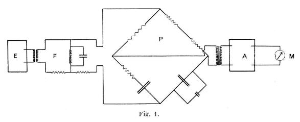
E: émetteur, F: filtre, P: pont de Wheatstone, A: amplificateur M: milliampèremètre.
