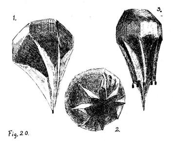
Au cours de l'ascension, lorsque le ballon est déjà assez haut, si sa partie pyramidale fut aspirée au start, elle est peu à peu chassée à l'extérieur, puis gonflée par la dilatation de l'hydrogène à l'intérieur du ballon.
