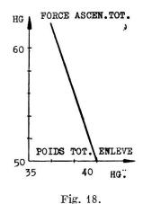
La vitesse ascensionnelle maximum du ballon correspondrait ainsi à une forme bien déterminée, variant quelque peu suivant son volume et la traction de la sonde avec ses accessoires sur les agrès.
