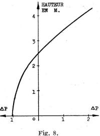
tion contrainte de l'enveloppe du ballon. L'action de l'hydrogène dans le haut du ballon et la pression atmosphérique sur sa base lui donnent une forme caractéristique de champignon, du genre bolet amer. En tenant compte des dimensions du ballon et des écarts de pression fournis par la courbe de la figure 8, à titre de contrôle, la poussée de l'hydrogène fut calculée; elle aurait été de 5.870 g, tandis qu'en réalité elle fut de 5.830 g; la concordance est donc très bonne.
