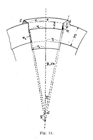
Considérons, en effet (voir fig. 11) une calotte sphérique circulaire, de rayon  $r_1$  et d'épaisseur E, découpée dans la croûte et se confondant, initialement, avec la surface de la sphère de
