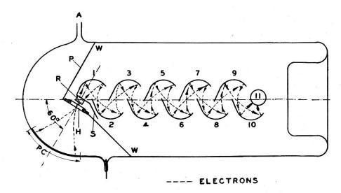
Fig. 24. Le multiplicateur à cloison.
