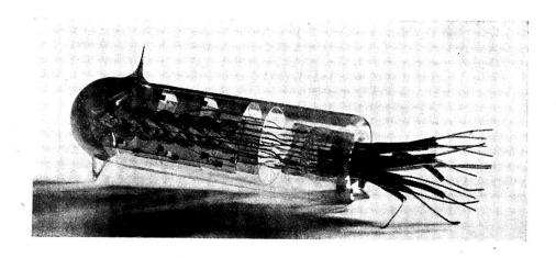
Fig. 26. Multiplicateur à cloison à 10 étages.
