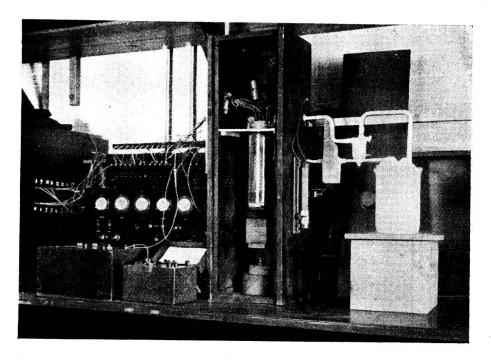
${\it Fig.~22.}$  Appareil pour la détermination des constantes thermiques.
