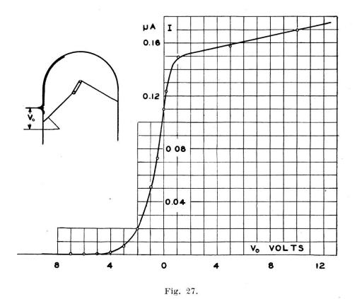
Courant résiduel en fonction du potentiel de la photo-cathode dans un multiplicateur à cloison.
