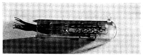
Fig. 21. Multiplicateur à 10 étages du type D.
