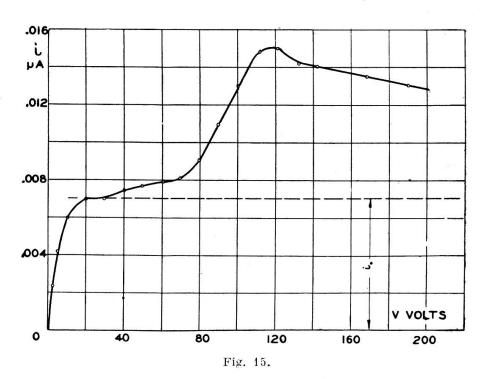
Courant de la photo-cathode en fonction du courant de sortie.
