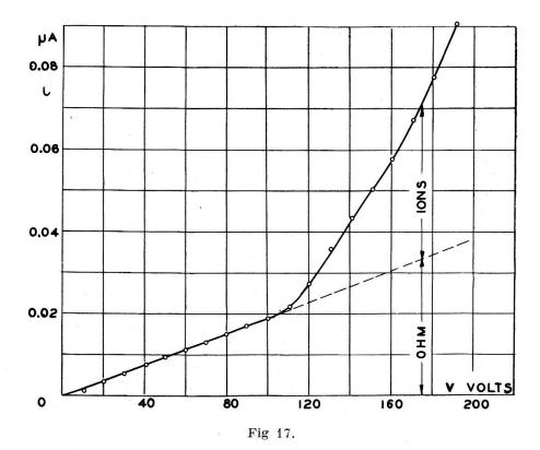
Courant résiduel en fonction de la tension par étage (type B).
