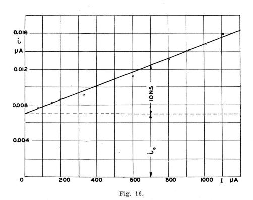
Courant de la photo-cathode en fonction du courant de sortie. Courbe de réaction ionique. Type B.
