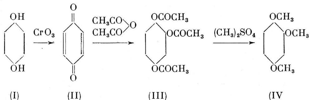
Le produit brut est redistillé deux fois sous pression réduite (point d'ébullition: 126°/12 mm). On obtient une huile presque incolore dont le point d'ébullition à la pression ordinaire est de 242,5° (littérature: 245-247°). Densité  $d_4^{26} = 1,1255$ ; indice de réfraction  $n_D^{26} = 1,53073$ .
