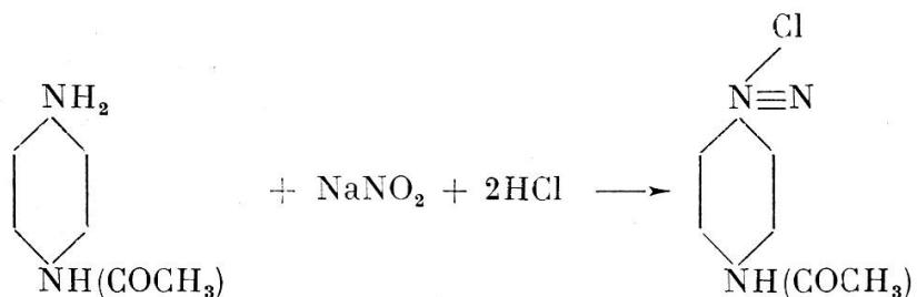
Le sel de diazonium obtenu est copulé sur l'oxyquinoléïne, en versant la solution alcaline chaude (NaOH) de ce dernier corps (5 grs) par petites portions dans la solution glacée du diazodérivé. Le colorant précipite en solution alcaline. Il est très soluble dans l'eau et les acides, d'où il reprécipite par alcalinisation. Par suite de cette forte solubilité du composé, le rendement de l'opération est très faible (lavages).
