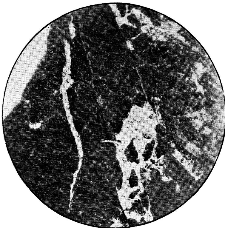
Microphotographie ( G = 12 \times ) d'une section polie d'un minerai de cuivre de Minduli (A.E.F.).
