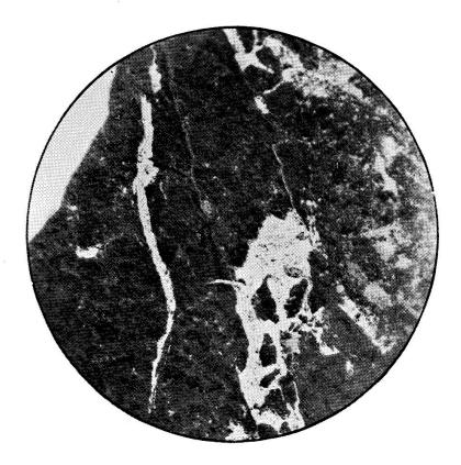
Microphotographie (G = 12 imes) d'une section polie d'un minerai de cuivre de Minduli (A.E.F.).
