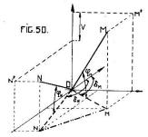
Connaissant au temps  $\theta_{(t-1)}$  la position du ballon-pilote (B) en N  $(\varphi_n, \vartheta_n)$ , puis au temps  $\theta_t$  sa nouvelle position en M  $(\varphi_m, \vartheta_m)$ , il s'agit de déterminer la projection horizontale du déplacement de B, soit  $\overline{nm}$ ; posons:
