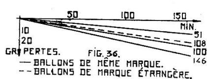
En tenant compte des pertes par diffusion, le volume  $\nu$  du ballon-pilote pourrait être exprimé (en fonction du temps) par une quantité de la forme:
