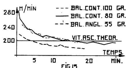
A Berlin<sup>1</sup>, en juillet 1931, quelques expériences furent faites pour comparer la vitesse ascensionnelle des ballons-pilotes non lestés et celle des ballons-pilotes lestés, par un dispositif d'éclairage pour les sondages nocturnes.
