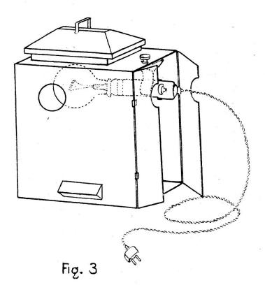
simultané de deux microscopes. Nous n'employons pas de lentilles collimatrices; ceci nous permet de rapprocher la source lumineuse du miroir du microscope, de manière à intensifier l'éclairage, tout en évitant la dispersion chromatique que donnent les simples lentilles collimatrices employées couramment.
