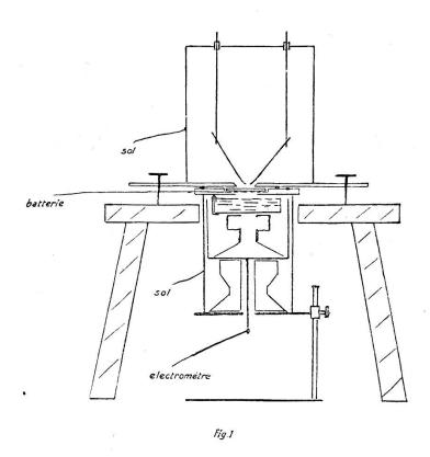
tapissé extérieurement d'une feuille d'étain. Un mince fil de platine plié au bord de la cuvette plonge par son extrémité supérieure dans le liquide étudié, vient se perdre par son extrémité inférieure dans l'épaisseur de la feuille d'étain; il est recouvert sur le bord extérieur de la cuvette, d'une goutte de paraffine.
